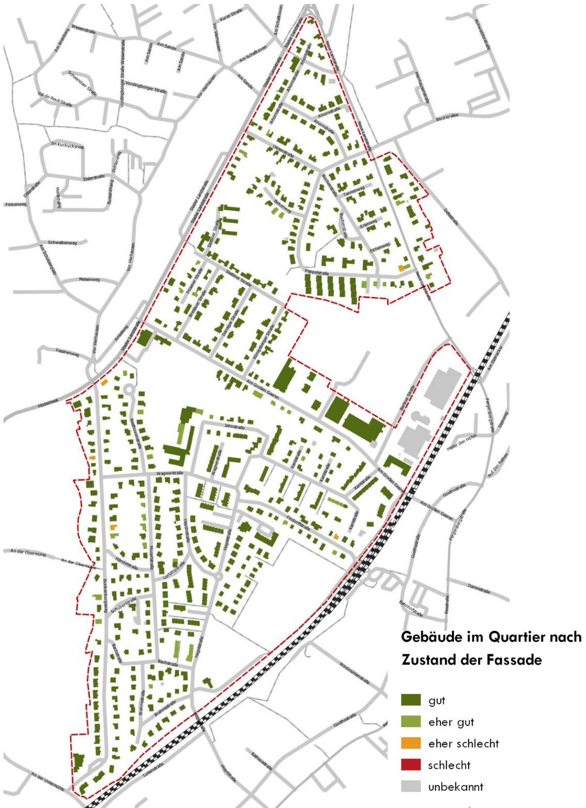
Abbildung 28: Gebäude im Quartier nach Zustand der Fassade 19
