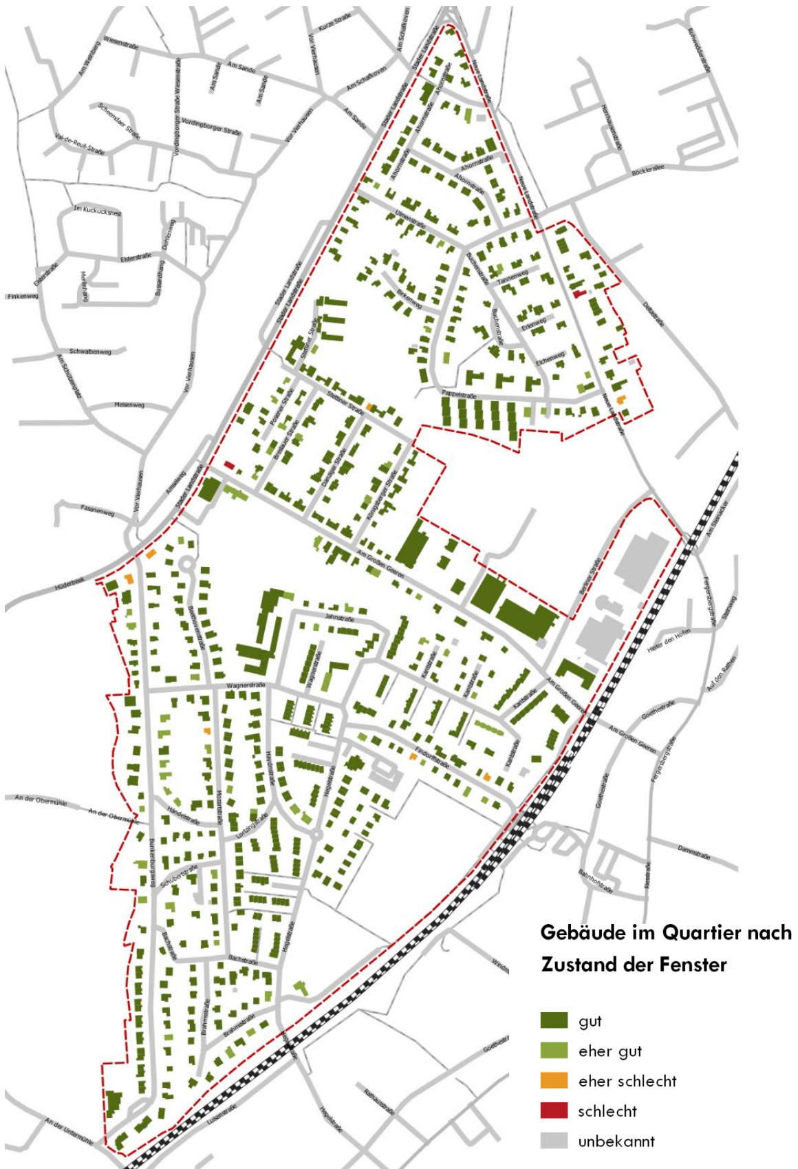
Abbildung 27: Gebäude im Quartier nach Zustand der Fenster 18
